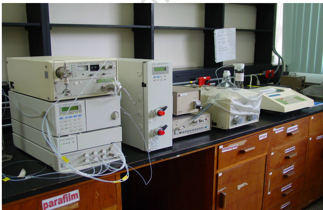
Equipo de cromatografía líquida (HPLC) utilizado en el análisis
